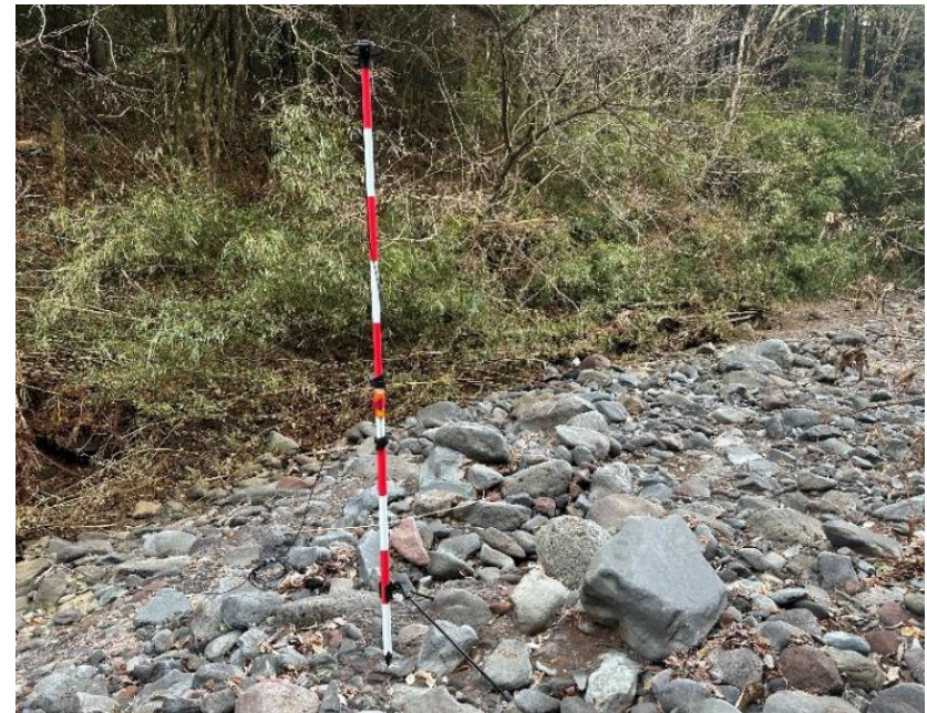
GNSSによる基準点設置
